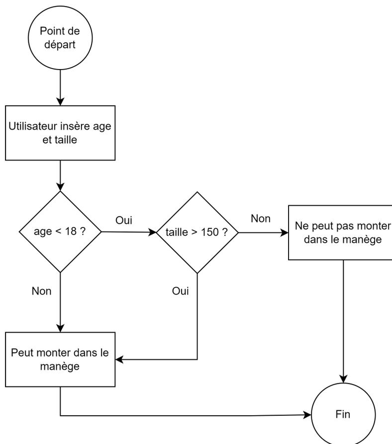
FIGURE 3.1 – Exemple de diagramme résumant un algorithme pour décider si une personne peut entrer dans un manège.
