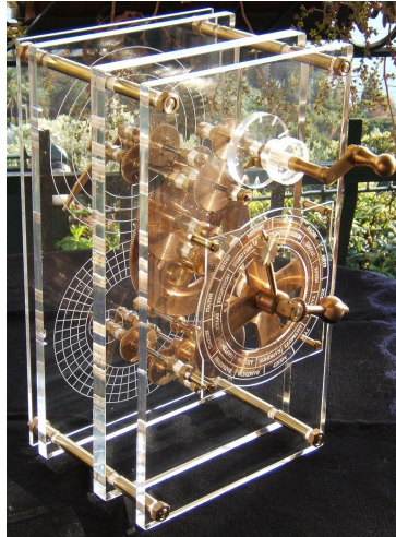
FIGURE 1.13 – Une proposition de reconstitution du mécanisme d'Anticythère en 2007. Auteur : I. Mogi, licence CC BY 2.5
