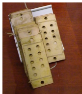
FIGURE 1.6 – Cartes d'instructions et de données qui auraient servi à coder l'information à donner en entrée à la machine analytique de Babbage, si celle-ci avait été terminée. Auteur : Karoly Lorentey, licence CC BY 2.0 DEED
